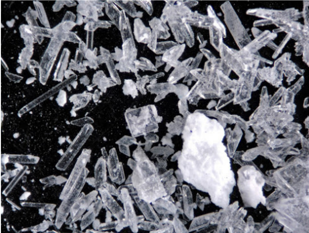
FIG. 4 Masas de cristales de yeso formados por alteración de hidroxiapatito en un 'lago' simulado rico en urea y epsomita. En el centro de la imagen se aprecia un cristal de newberyita.
