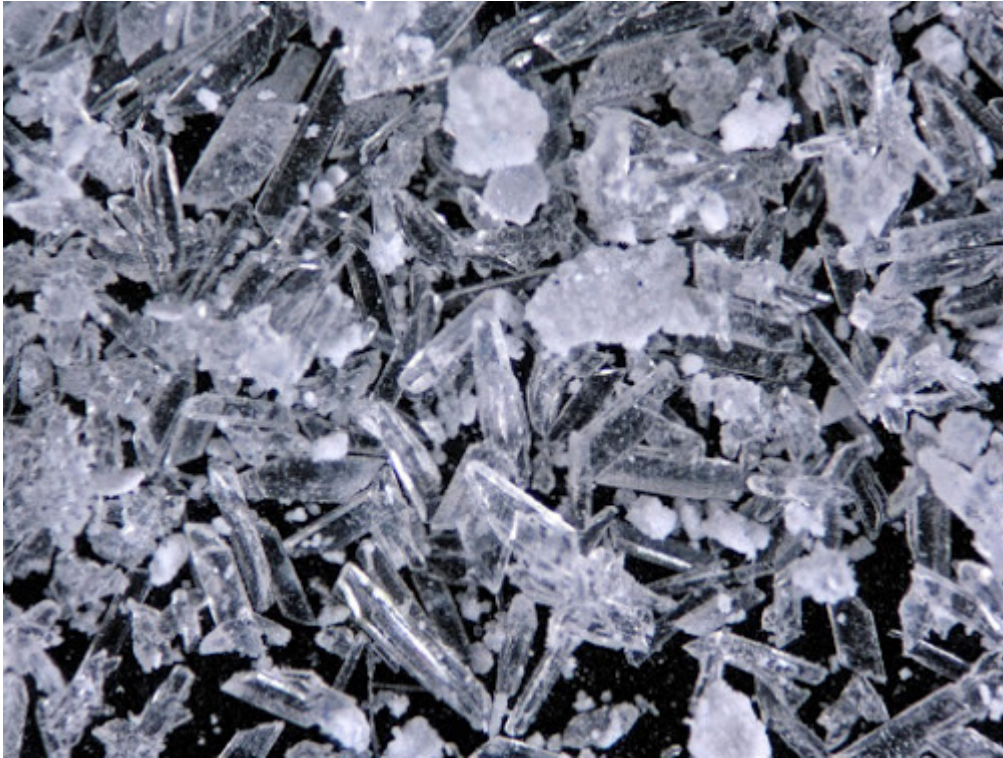
FIG. 5 Masas de cristales de yeso formados por alteración de hidroxiapatito en un 'lago' simulado rico en urea y epsomita.
