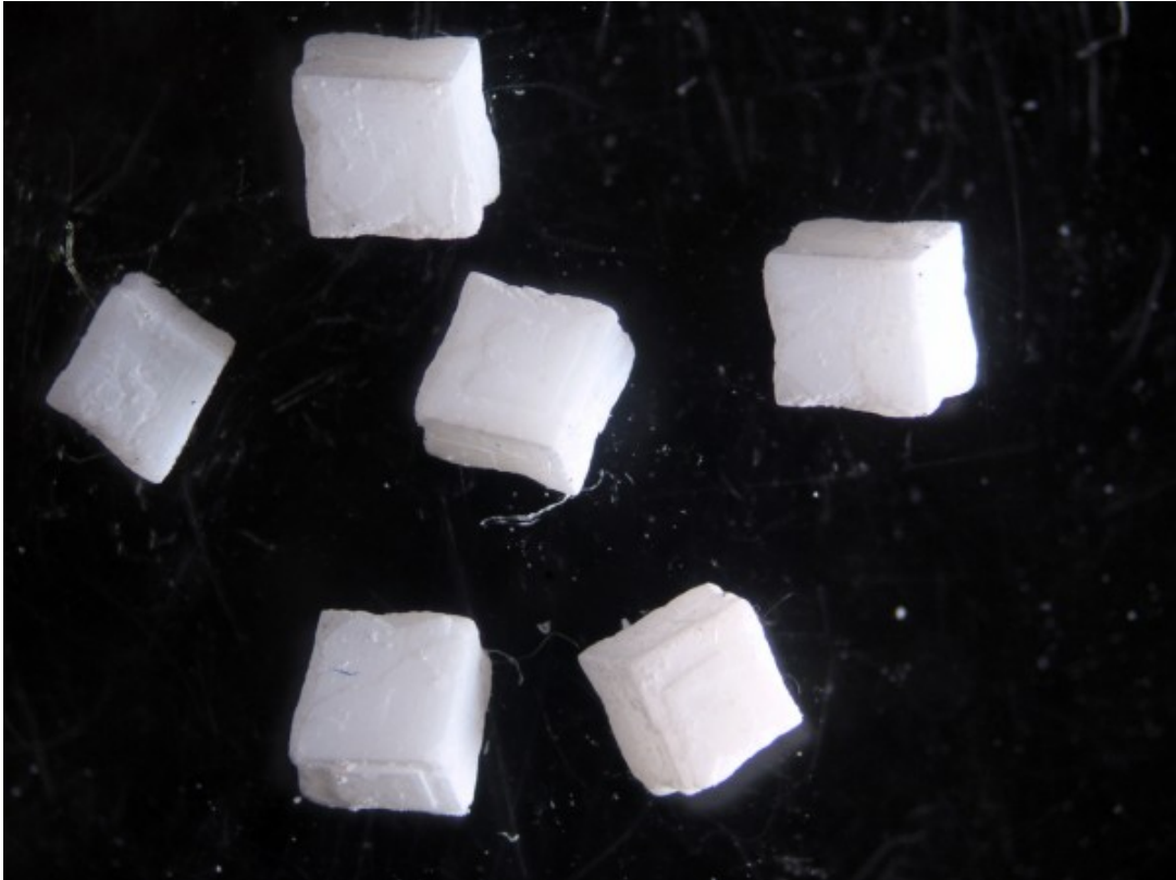
Cristales romboédricos de Calcita, obtenidos a partir de cloruro de calcio y de carbonato sódico. Un experimento interesante es modificar las condiciones para obtener aragonito en lugar de calcita...
