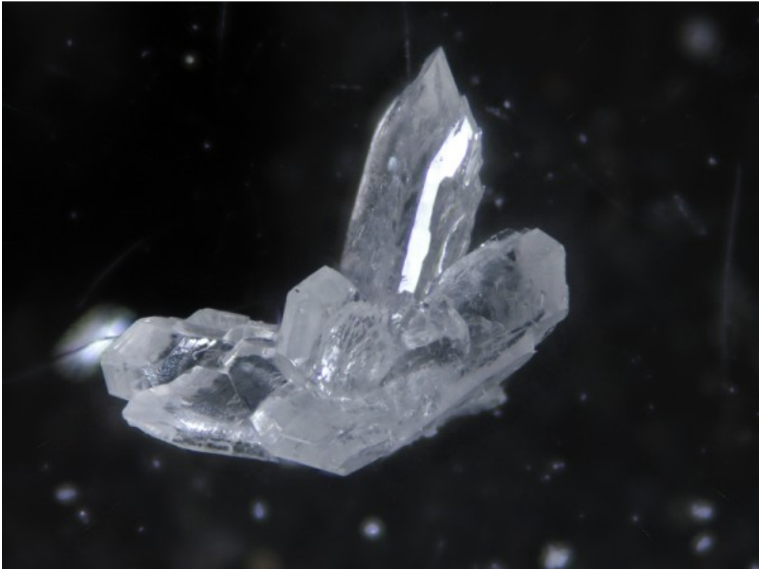
Grupo de cristales de yeso (sulfato de calcio) obtenidos a partir de \text{CaCl}_2 y \text{Na}_2\text{SO}_4
