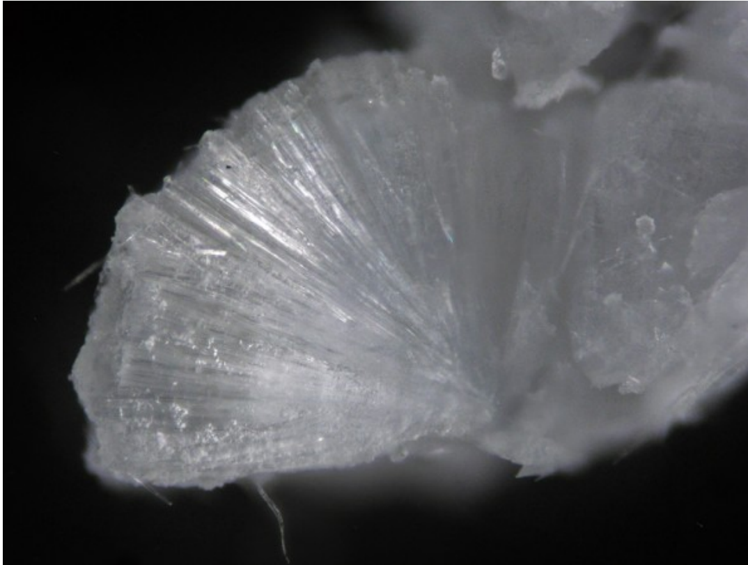
El hidroxilapatito tiende a formar, en estas condiciones, bonitos grupos radiales de cristales aciculares...
