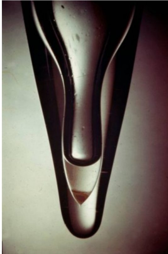
Primera muestra de americio (hidróxido de americio) de la Tierra: obtenida en el laboratorio de Glenn T. Seaborg en los años 40.
