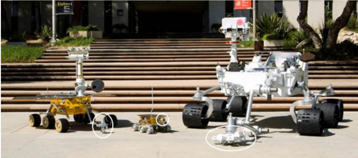
Retrato de familia de los rovers de exploración de Marte. De izquierda a derecha, el Spirit, el Sojourner y el Curiosity. En un círculo, la localización de los instrumentos APXS de cada uno de ellos.
